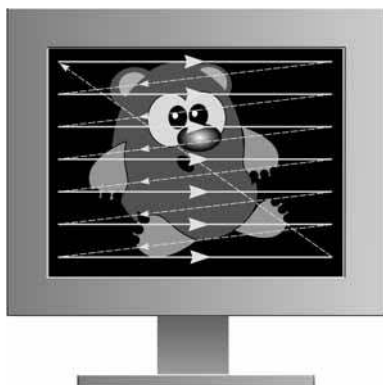
Рис. 2.1. Развёртка изображения на экране монитора
